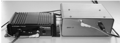
Fig. 5 GPS front-end (left: TCXO, right: OCXO).
